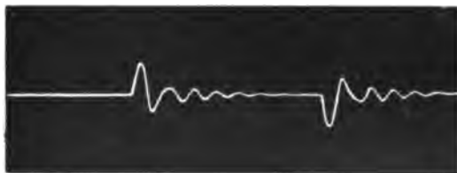
Abb. 265. Oszillographische Aufnahme des Stromes einer periodischen Entladung und darauffolgender Ladung.
